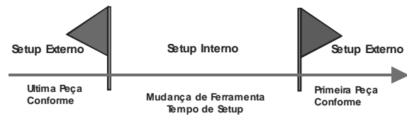
Figura 2. Componentes do tempo de setup .
